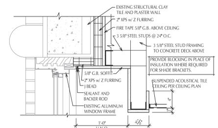
**Window Soffit Detail**
