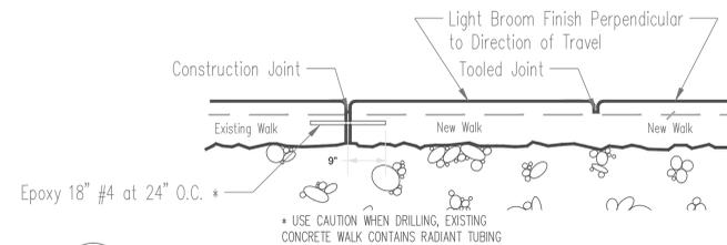
7 CONCRETE SIDEWALK JOINTS
