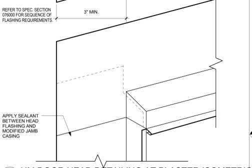
6 HM DOOR HEAD DETAILING AT PLASTER ISOMETRIC
