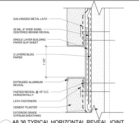
4 A8.36 TYPICAL HORIZONTAL REVEAL JOINT
