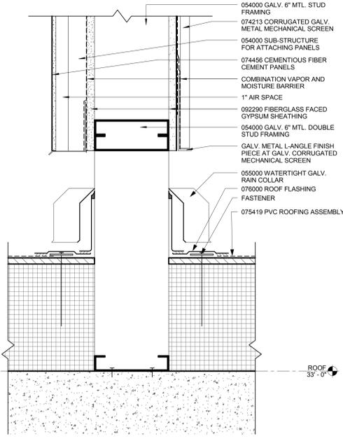
10 SECTION AT MECHANICAL SCREEN - SILL
