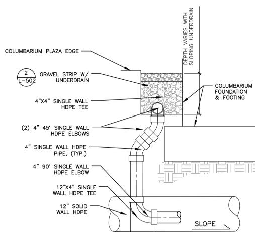
3 UNDERDRAIN CONNECTION TO STORM DRAINAGE SYSTEM
