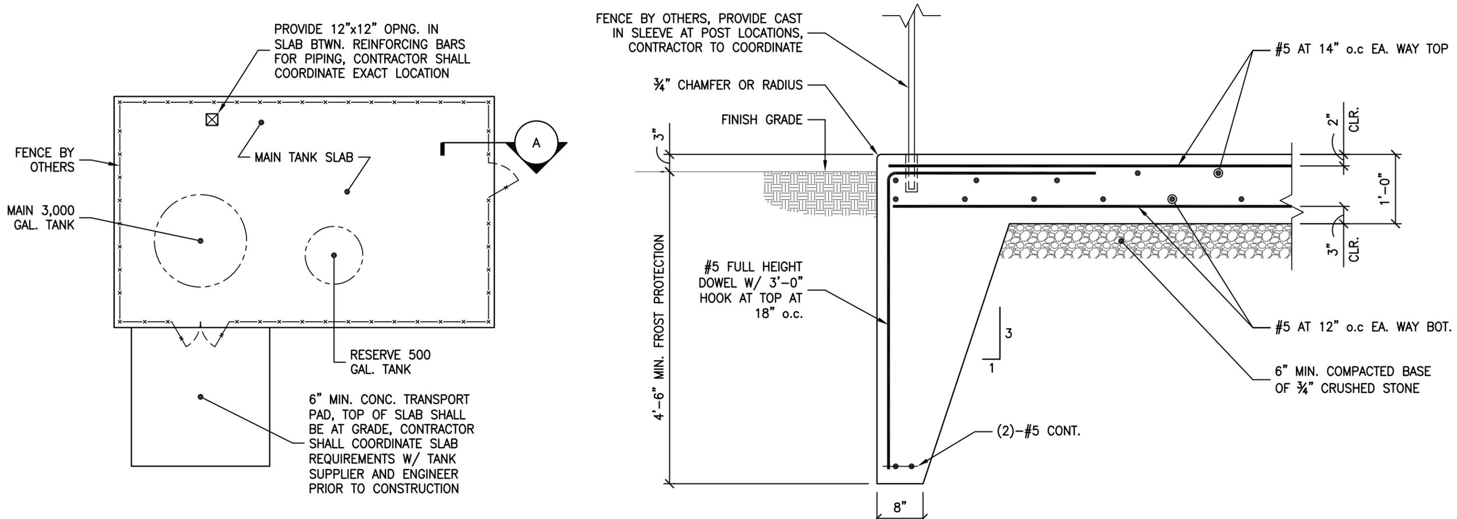
**OXYGEN TANK SLAB PLAN**
