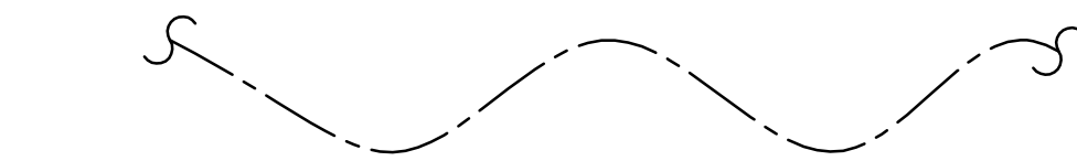
DATA CABLE CONDUIT (CAT5E, FIBER OPTIC, RS232, RS485)
