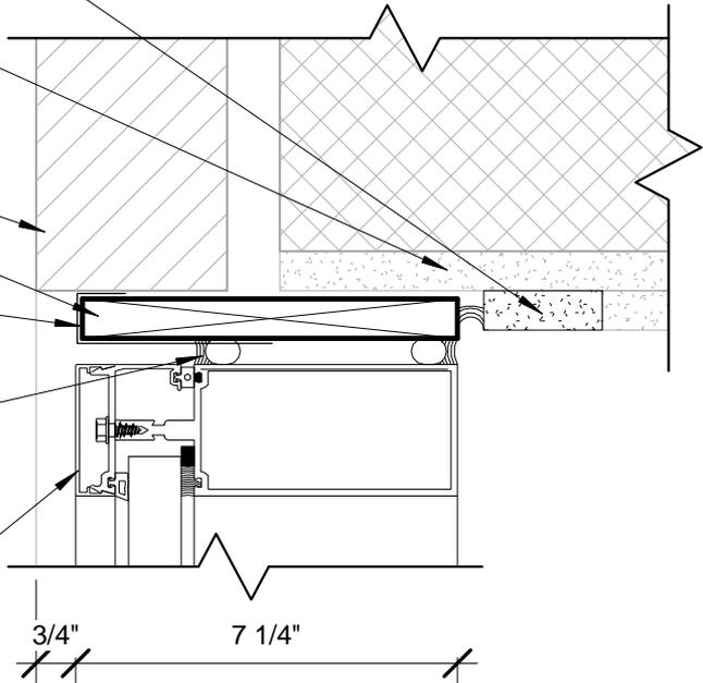
JAMB DETAIL @ FLUSH BRICK (TYPICAL FOR WINDOW TYPE 1A, 1D, 1F, 1G, 1H, 1J, 1K, 1X, 2A. VARIANT FOR TYPE 1C.)
