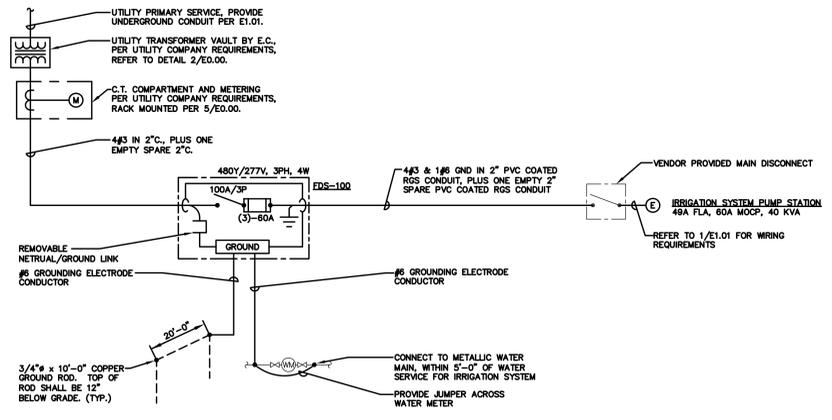
1 IRRIGATION SYSTEM ONE-LINE DIAGRAM
