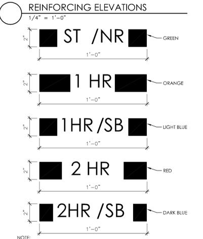
**ABOVE THE CEILING SPRAY PAINT IDENTIFICATION SYSTEM FOR RATED WALLS**
