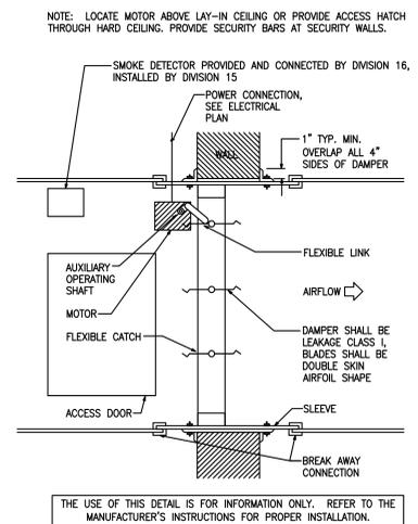
**COMBINATION SMOKE AND FIRE DAMPER DETAIL**
