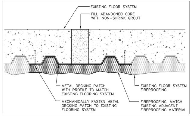
**2 FLOOR SLAB PENETRATION REPAIR**
