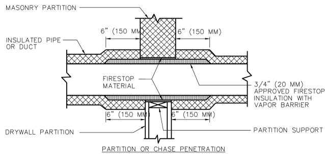
**1 PIPE/DUCT PENETRATION OF FIRE/SMOKE BARRIERS**
