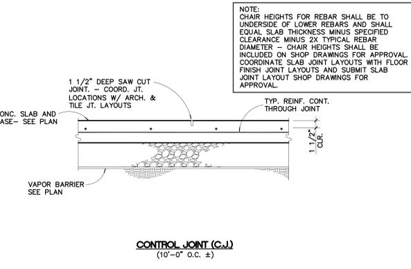
**TYPICAL SLAB CONTROL JOINT (C.J.) AND DOWELED JOINT (D.J.)**
