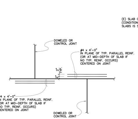
**REINFORCING AT OFFSET SLAB JOINTS**
