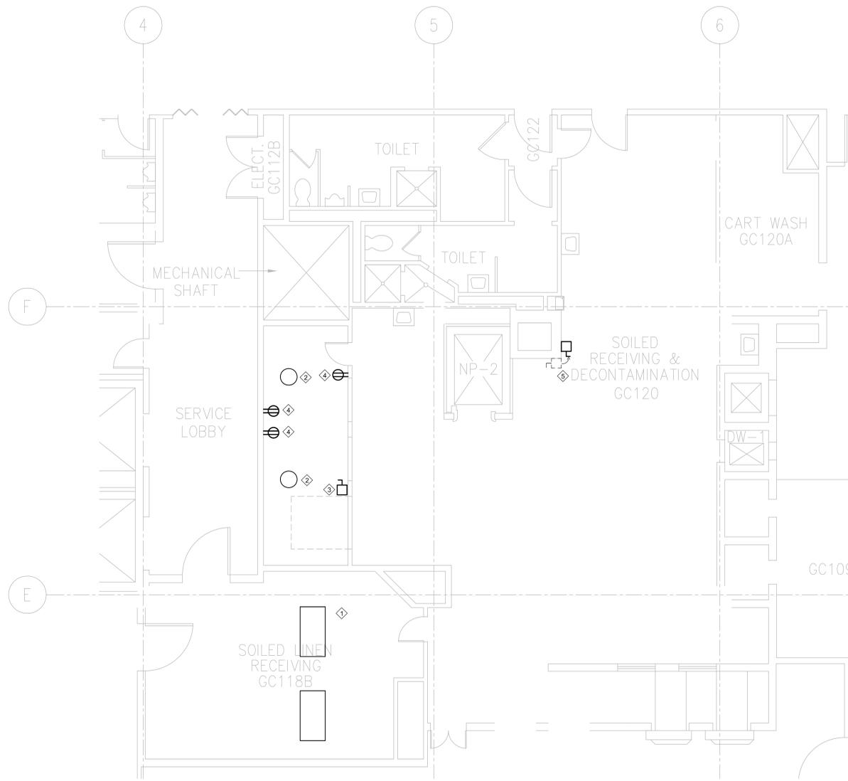
**E1** GROUND FLOOR PART PLAN - ELECTRICAL DEMOLITION WORK
