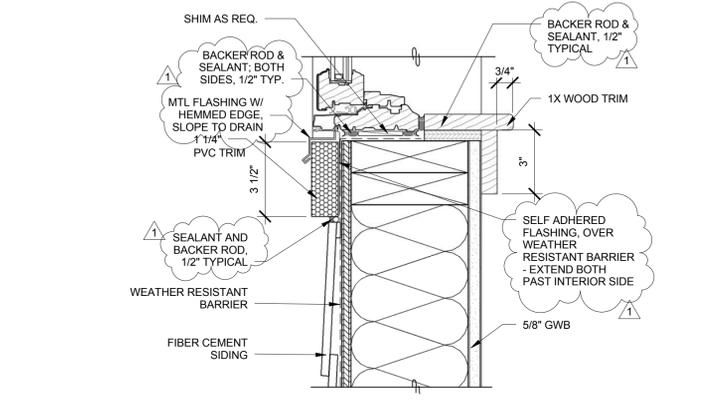
9 WINDOW SILL AT FIBER CEMENT SIDING
