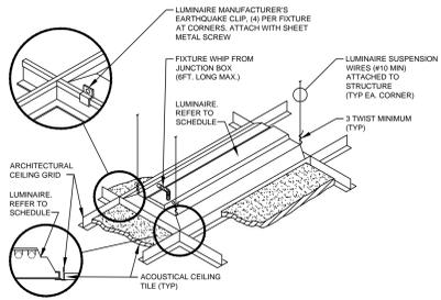
**E2 LUMINAIRE MOUNTING - LAY-IN CEILING**
