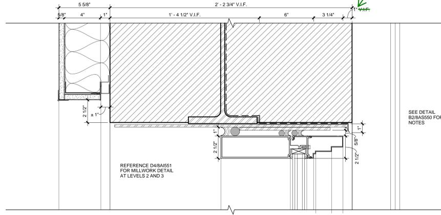
**B2** SECTION THRU DIXIE INFILL WINDOW HEAD AT LEVEL 1 TULANE MASONRY WALL
