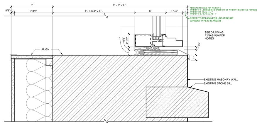
**D4** SECTION THRU DIXIE INFILL WINDOW AT BRICK SILL
