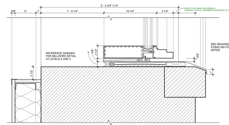
**F2** SECTION THRU DIXIE INFILL WINDOW SILL AT LEVEL 1 TULANE MASONRY WALL
