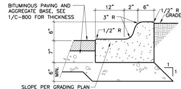
4 CONCRETE CURB & GUTTER (B612)
