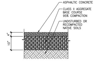
1 TYPICAL ASPHALT PAVING 1"=1'-0"
