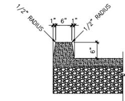
3 ROLLED ASPHALT CURB 1"=1'-0"
