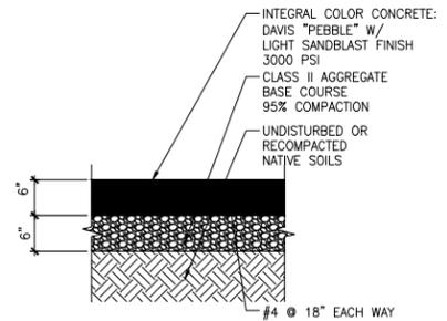
5 TYPICAL CONCRETE PAVING 1"=1'-0"
