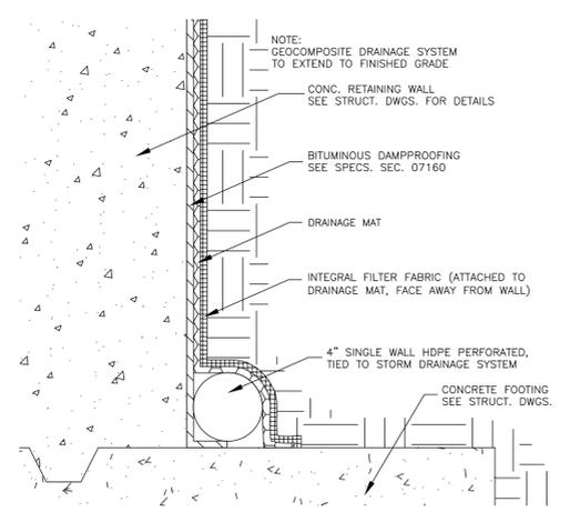
**4 GEOCOMPOSITE DRAINAGE SYSTEM**
