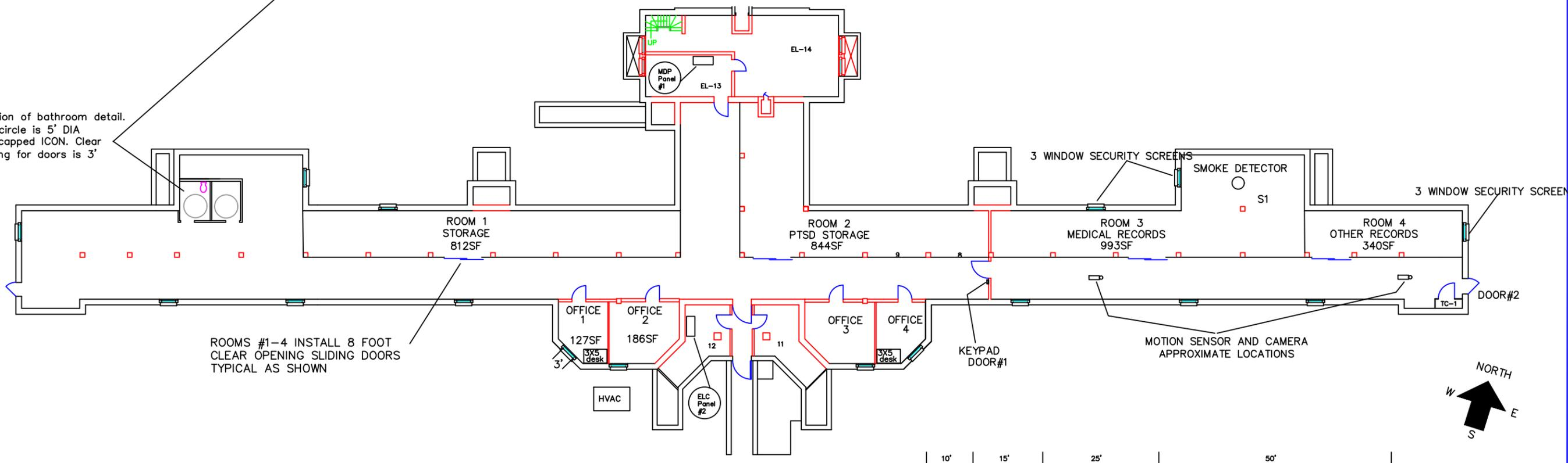
ROOMS #1-4 INSTALL 8 FOOT CLEAR OPENING SLIDING DOORS TYPICAL AS SHOWN
