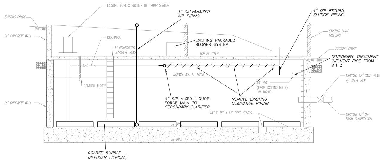
**EQUALIZATION TANK SECTION - NEW WORK**
