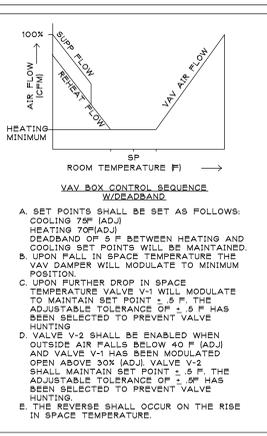
VARIABLE AIR VOLUME (VAV) TERMINAL UNIT CONTROL DIAGRAM
