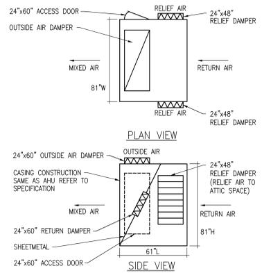
**CONSTRUCTION DETAIL FOR AHU-2 & 3 ECONOMIZER SECTION**
